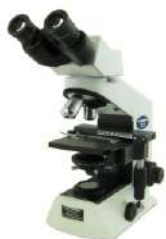
Световой микроскоп Olympus BX-23 для бактериологических исследований и определения болезней пчел
