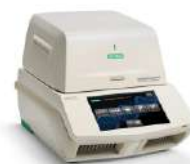
Амплификатор в режиме реального времени CFX96 Touch + RU ПО используется для ПЦР диагностики вирусных и бактериальных болезней пчел, а также для исследования продукции пчеловодства на ГМО и ГМИ
