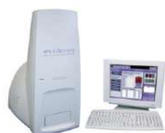
Прибор Randox Investigator для скрининговых исследований, для качественного определения содержания антибиотиков в мёде и в продуктах пчеловодства
